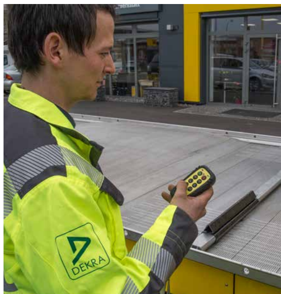
Mit der Funkfernbedienung steuert Hess-Fahrer Manuel Kehres alle Ladevorgänge aus sicherer Position: Rampen aus- und einfahren, Plateau ab- und wieder in die Waagrechte kippen.
